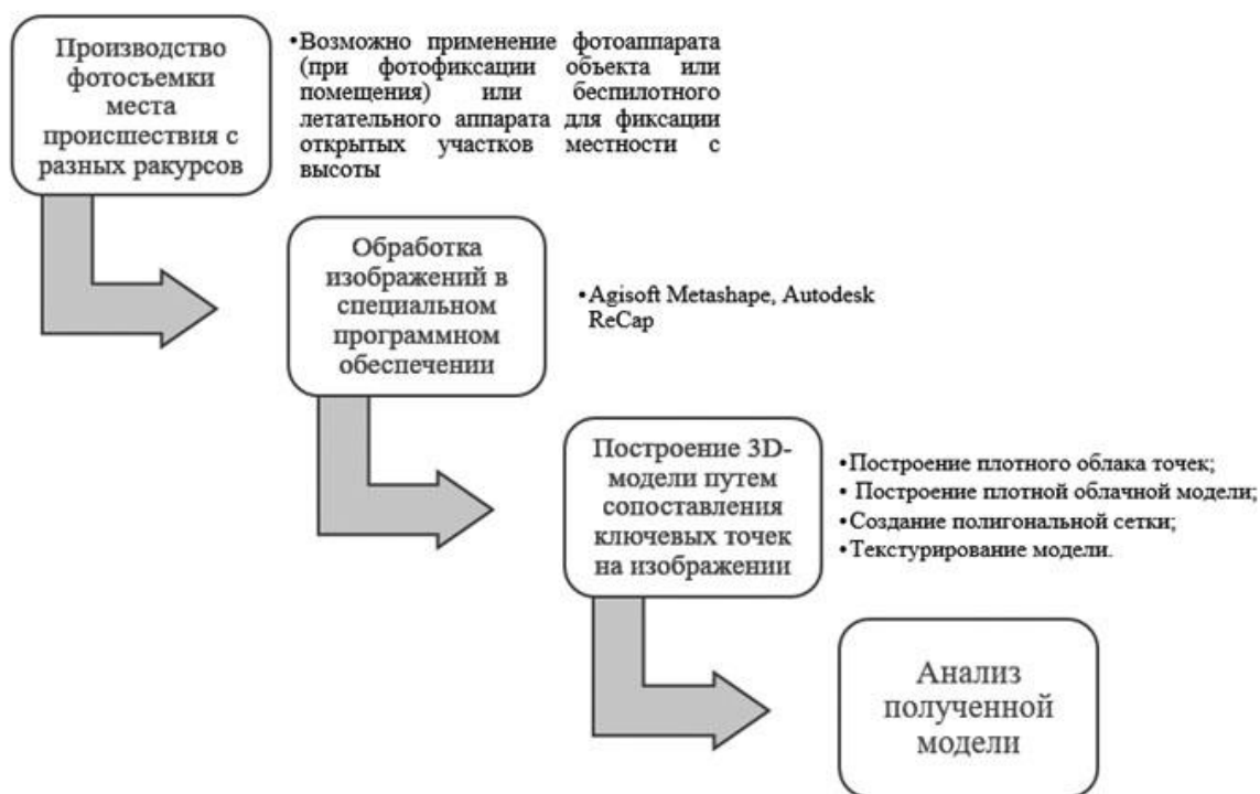
Рис. 4. Общий алгоритм создания 3D-модели методом фотограмметрии
